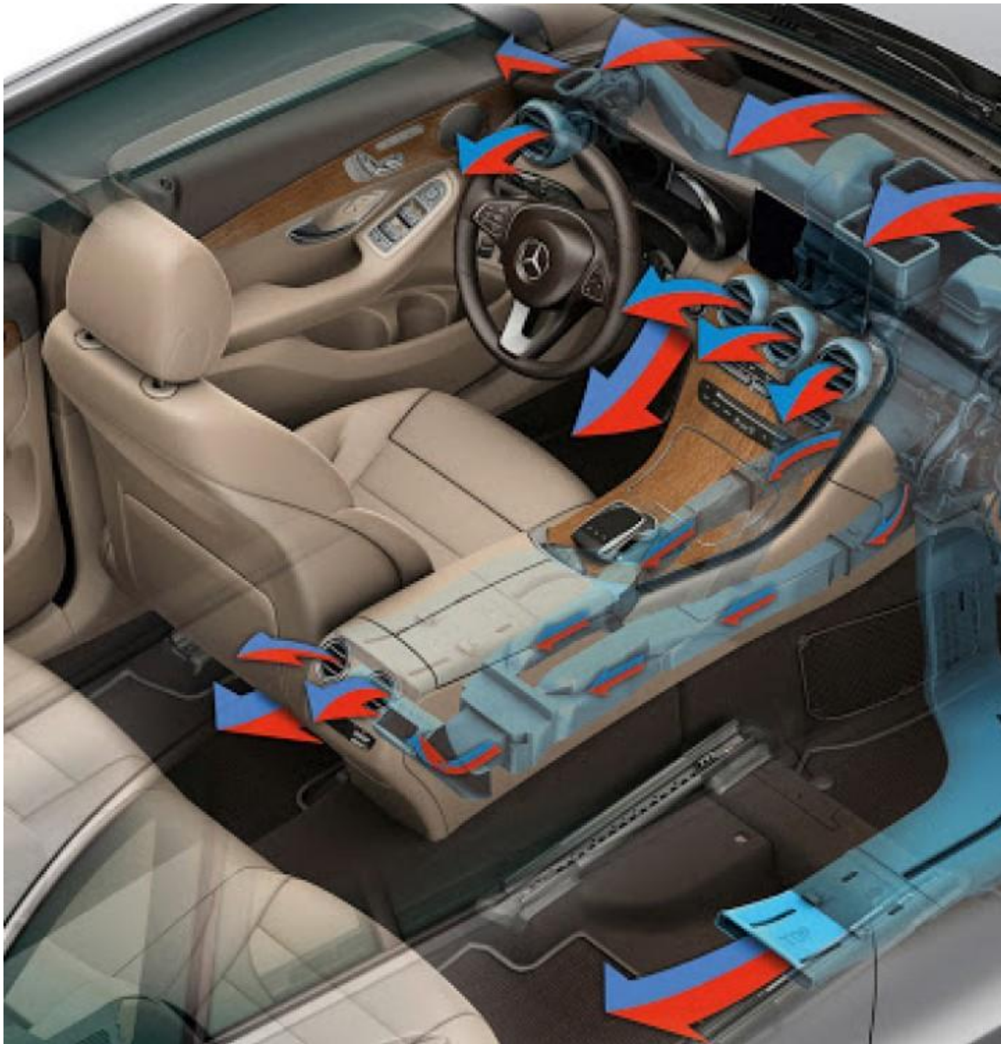
Hệ thống điều hòa giúp làm mát không khí trên xe ô tô (Nguồn: Sưu tầm)
